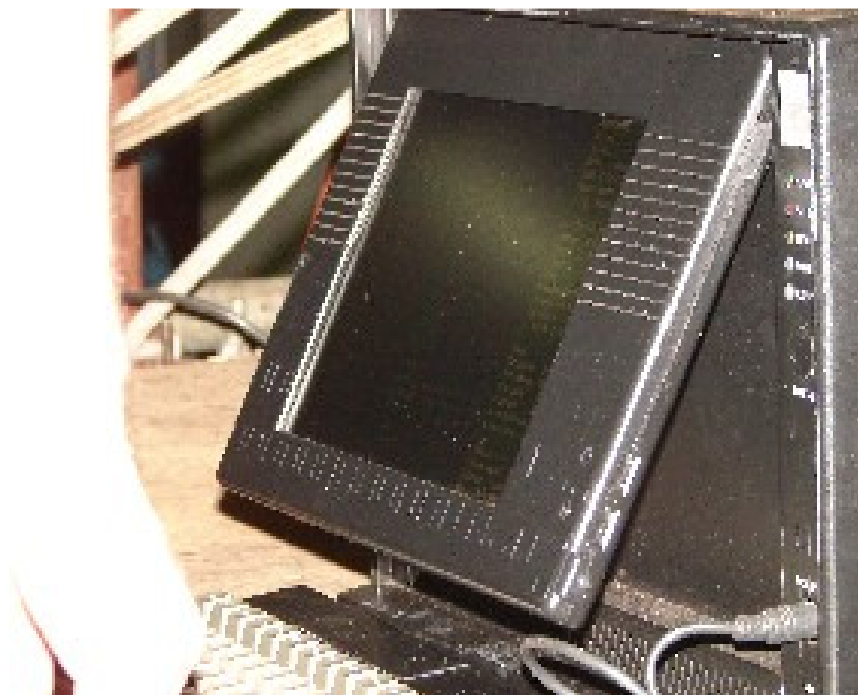
Figura 4. 11 – Vista de aparelho de análise e registro de dados de medição de espessura
